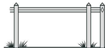
Clôture avec 1 lisse Section 12 x 12 Hauteur hors-sol 0,50 m ou 0,70 m
