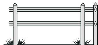
Clôture avec 2 lisses Section 12 x 12 Hauteur hors-sol 1 m ou 1,20 m
