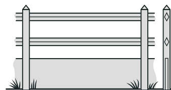
Clôture avec 2 lisses et dalle 0,25 m ou 0,50 m Section 12 x 12 Hauteur hors-sol 1,25 m ou 1,50 m
