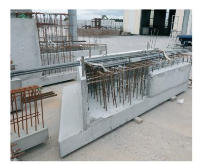
Les éléments de structure linéaires (longrines, poutres, poteaux) forment l'ossature d'un bâtiment. La fabrication est réalisée sur mesure à partir des plans fournis par le bureau d'études structure du chantier.
